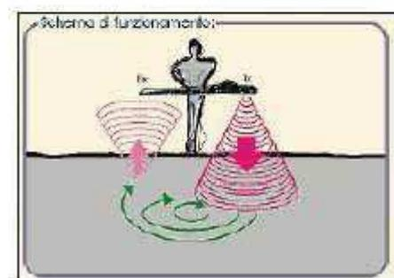
Poiché un campo magnetico a frequenza minore si attenua più lentamente in un qualsiasi mezzo, la profondità d'esplorazione varia con la frequenza di trasmissione. A
